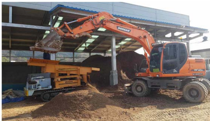
그림 21. 로터리 스크린을 이용한 목재칩 선별작업
