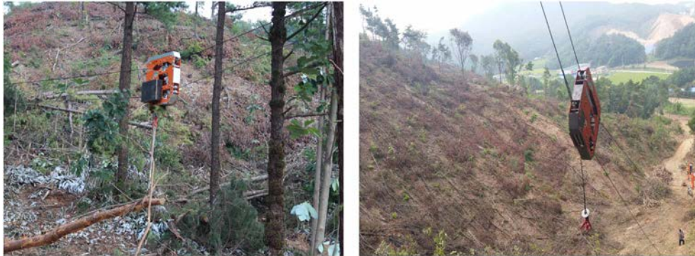
그림 14. 개발된 2중 클램프 반송기의 현장 적용성 시험
